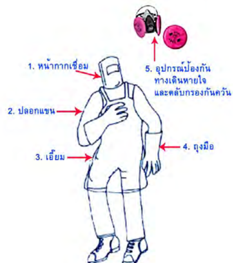
รูปที่ 9 อุปกรณ์ป้องกันอันตรายส่วนบุคคลในตำแหน่งงานเชื่อม
