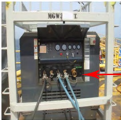
รูปที่ 14 ตัวอย่างการตรวจเช็คข้อต่อสายลมก่อนใช้งาน
