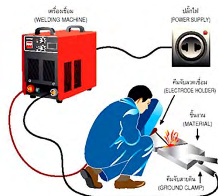
รูปที่ 20 องค์ประกอบของการเชื่อมด้วยไฟฟ้า
