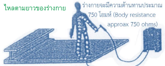
รูปที่ 10 ณ แรงดันวงจรเปิด (OCV) จะมีแรงดันที่ 80V มีค่ากระแสไฟฟ้าที่ 107 mA)
