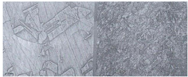
รูปที่ 4 โครงสร้างเกรนหยาบหลังจากบัดกรีแข็ง (ซ้าย) และเกรนละเอียดของวัสดุที่ไม่ได้บัดกรี (ขวา)
