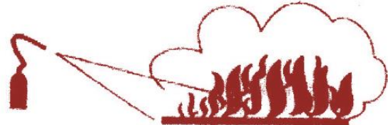
รูปที่ 5 ให้เริ่มดับไฟจากด้านหน้าหรือจากด้านในจนกระทั่งไฟดับ (Extinguish surface fires starting from the front)
