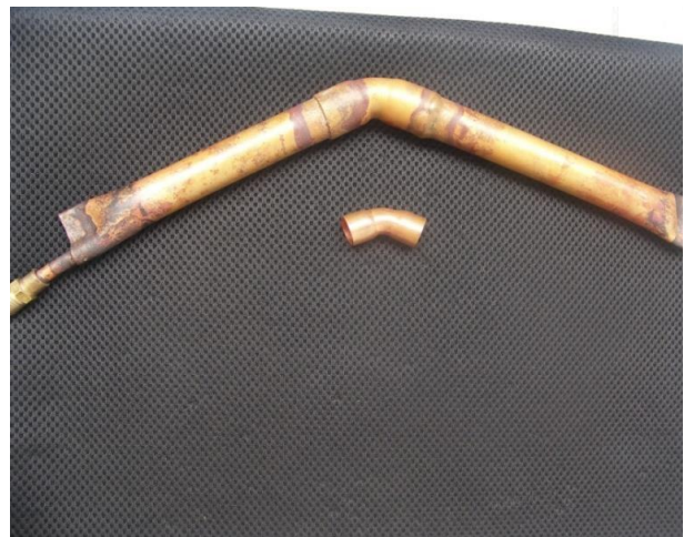
รูปที่ 3 ข้ออทองแดงที่เสียหาย – ข้ออมีรอยร้าวด้านใน
