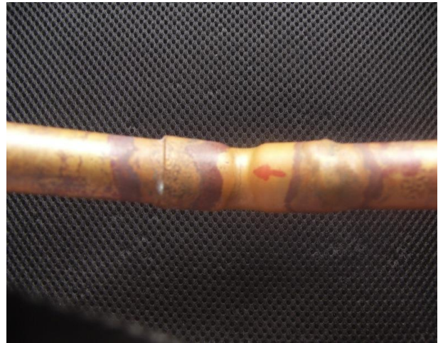
รูปที่ 2 ท่อโค้งที่มีรอยร้าวด้านในข้อต่อโค้ง (ข้างล่างข้ออทองแดงที่ยังไม่ได้ใช้งาน)
