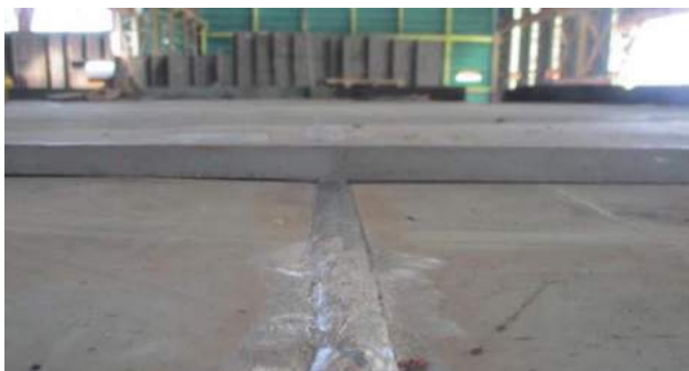
รูปที่ 8 ตาดฟ้าเรือ (Deck plating) ที่เกิดการบิดตัวภายใต้กระบวนการเชื่อมแบบใต้ฟลักซ์
