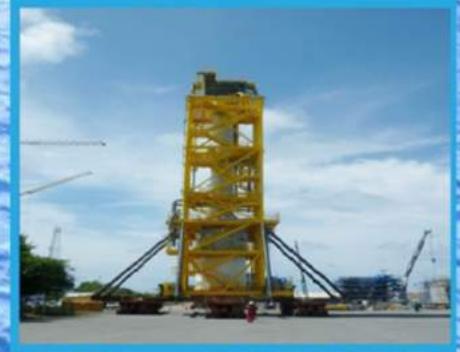
หอแยก Condensate เพื่อใช้ผลิต Gas Offshore
